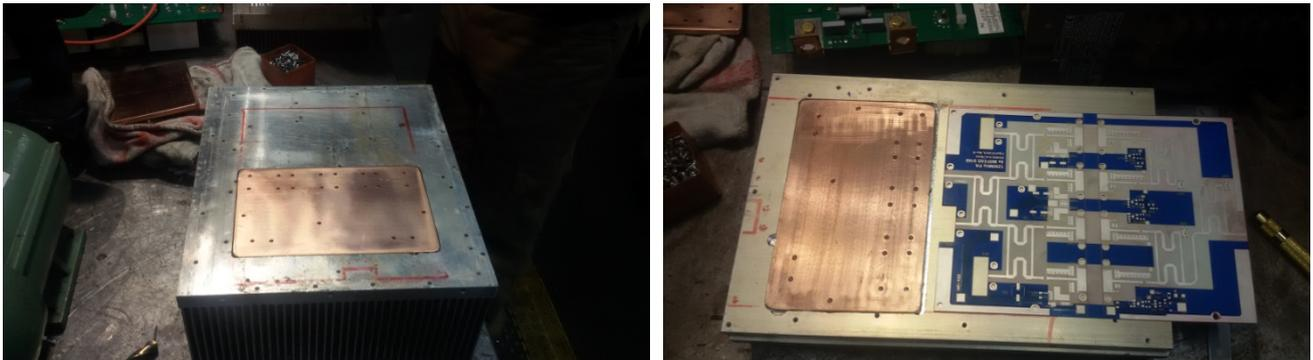
Dopo una settimana d'intenso lavoro sono state realizzate tutte le parti meccaniche di tutti e 3 gli amplificatori e si è passati all'assemblaggio del primo di questi montando le schede di ingresso e uscita con le polarizzazioni, gli ATC, le resistenze di carico ecc.
