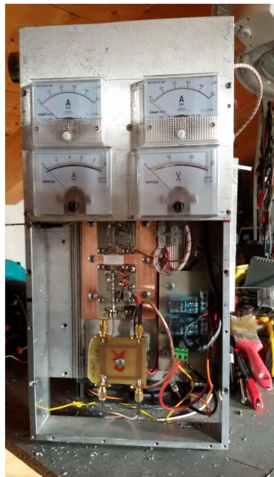
Nel test di compressione spinta con 50W all'anello ibrido divisore di ingresso delle 2 schede e con una corrente totale assorbita dai 2 amplificatori più il driver e servizi di oltre 90 A aumentando la tensione sotto carico fino a 30 V ai Mosfets abbiamo ottenuto letture di 1.035 W al connettore 7/16 di uscita. Ci siamo riusciti .
