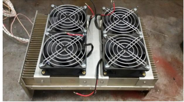
A questo punto con 10 W di pilotaggio a 28V ne uscivano 300 di W senza ancora ottimizzare gli ATC in uscita e in ingresso.
